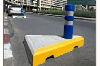
Marerial: Base de Hormigón Gris con Armadura Galvanizada.caucho reciclado ó PVC relleno de hormigón, Hito de PVC reflexivo, color azul de 50 cm. altura. Placas blancas con vinilo reflectante. Peso Aprox: 350 Kg. Sistema Colocación: Apoyado y anclado al suelo con espárragos de acero. Colores: Gris Texturas: Liso
